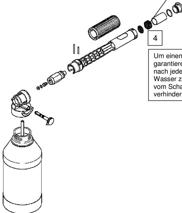
Um einen korrekten Betrieb zu garantieren, ist die Schaumlanze nach jeder Benutzung mit klarem Wasser zu spülen. Eine Verstopfung vom Schaumsieb (4) wird dadurch verhindert.
