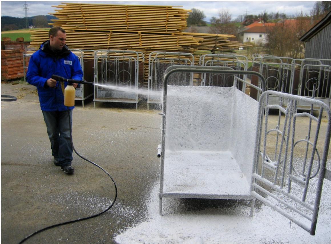
Die Schaumlanze für den Hochdruckreiniger ermöglicht durch einfaches und flächendeckendes Aufsprühen des Reinigungsschaums eine effektive und schnelle Reinigung. Ein mittlerer Melkstand lässt sich in ca. 5 min einschäumen. Dünn aufgetragen bleibt der Schaum haften und nach einer Einwirkzeit von 20 min kann der Schaum wieder abgespült werden. Der Melkstand ist sauber.
